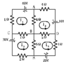
回路( $I_2$ )中的电流 $I_2$ 也流经回路( $I_1$ )的一部分，即从A到B的分支，对应的电压降为 $-4I_2$ ；
