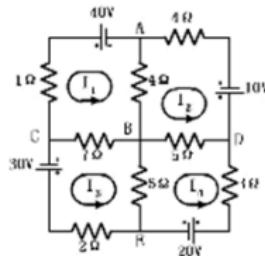
利用希尔霍夫电压定律，可得图中回路电流所满足的关系式.
