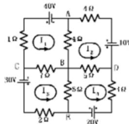
回路( $I_2$ )中的电流 $I_2$ 也流经回路( $I_1$ )的一部分，即从A到B的分支，对应的电压降为 $-4I_2$ ；同样，回路( $I_3$ )中的电流 $I_3$ 也流经回路( $I_1$ )的一部分，即从B到C的分支，对应的电压降为 $-7I_3$ .
